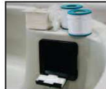
Извлечь два фильтра для проведения их очистки.
